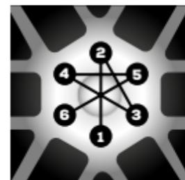
Il est nécessaire de suivre les instructions du constructeur du véhicule ou du fabricant des jantes de rechange pour déterminer les couples de serrage des boulons.
