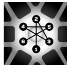
É necessário seguir as instruções do fabricante do veículo ou do fabricante dos aros de reposição para determinar os binários de aperto dos parafusos.
